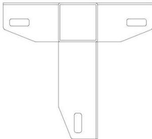
Detail Anschlußpunkt Tragschiene
