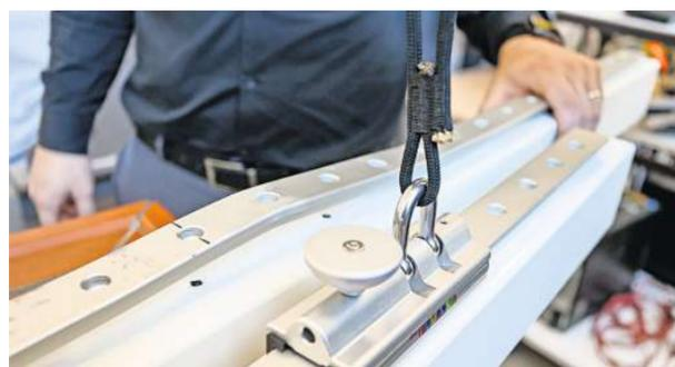
Rechts sieht man die noch funktionsfähige Schiene, links die bereits maximal strapazierte.
