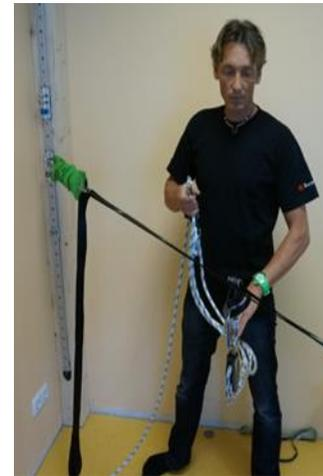
**Der Flaschenzug ist nicht als Befestigungsmittel für das Schwebetuch zu verstehen, sondern dient lediglich als Aufspannhilfe! Eine Benutzung des Schwebetuchs mit installiertem Flaschenzug ist nicht vorgesehen und kann zu Unfällen führen!**
