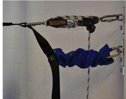
Der Flaschenzug wird entspannt und kann jetzt leicht wieder ausgebaut werden. VORSICHT: Achten Sie beim Lösen der Seilklemme darauf, dass Sie dies mit möglichst flacher Hand und ausreichend Abstand zur Seilklemme tun, da sich bei Entspannung das Seil einzieht und Finger quetschen können.
