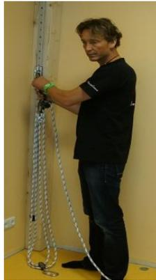
Das andere Ende des Flaschenzugs (Seite B) wird in das Gurtband eingehängt, möglichst nah am Tuch.
